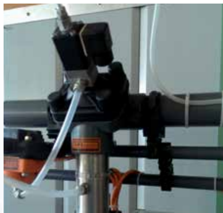
Kreislaufsystem mit paralleler Medikationsleitung
