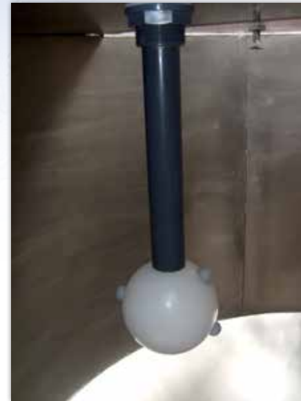
Anmischbehälter mit Spülkopf und Nebeldüse
