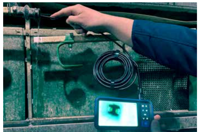
Mithilfe der Kamera ist zu sehen, dass sich ein geringfügiger Biofilm gebildet hat.
