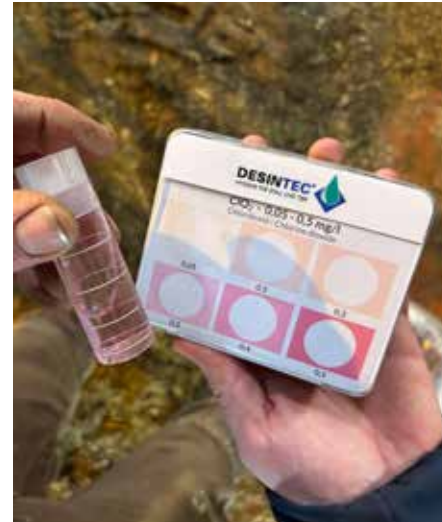
Wie sich das Chlordioxid vorgearbeitet hat, zeigt die Färbung des Wassers nach dem Testen.
