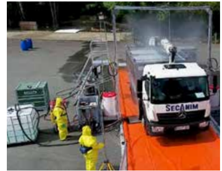
Alle Fahrzeuge, die das von ASP betroffene Betriebsgelände befahren oder verlassen, müssen eine mobile Desinfektionsanlage durchfahren. Hier werden sie von allen Seiten gereinigt und desinfiziert.
