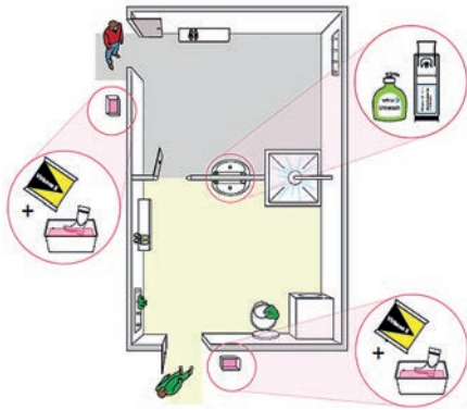
Aufbau einer Hygieneschleuse im Stall.
