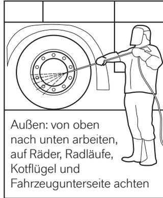
Außen: von oben nach unten arbeiten, auf Räder, Radläufe, Kotflügel und Fahrzeugunterseite achten
